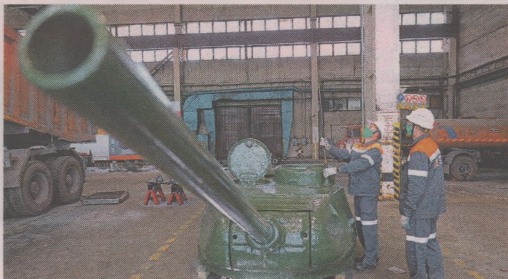
↑ Участники проекта по восстановлению Т-34 отремонтировали люки командира и экипажа, антенны передатчика танка, покрасили башню
